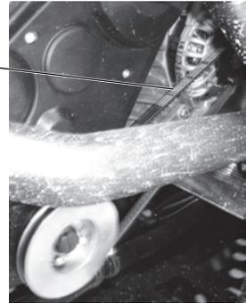
3. Wenn die Riemenspannung nicht stimmt, die Montageschraube und die Einstellschraube lösen..
