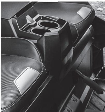
1. Vor dem Einlegen der Feststellbremse die Fußbremse betätigen.
