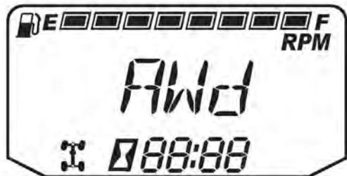
Nach der Zuschaltung bleibt der Allradantrieb (AWD) aktiv, bis der Schalter ausgeschaltet wird. Schaltet man den Schalter aus, während das bedarfsgesteuerte Antriebssystem in Bewegung ist, kuppelt sich dieses erst aus, wenn die Hinterräder wieder Bodenhaftung haben.
